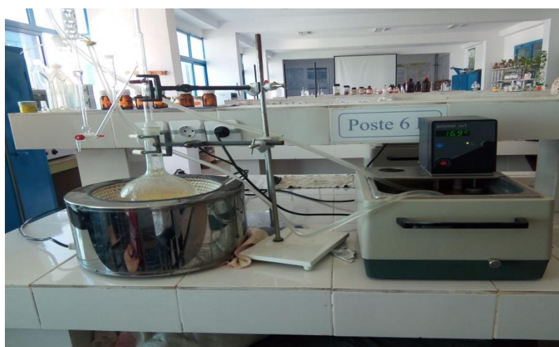
Figure 22: Montage pour l'hydro distillation (laboratoire de pharmacognosie Faculté de Médecine USB C3) (image personnelle)
